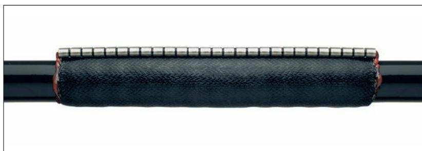
Армированные стекловолокном манжеты RFSM предназначены для быстрого и надежного ремонта кабелей и применяются там, где требуется повышенная механическая прочность. На внутренней поверхности манжеты нанесен термоплавкий клей. Манжеты RFSM могут быть использованы в качестве наружного покрова в муфтах низкого и среднего напряжения.
