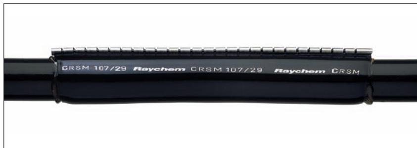
Ремонтные манжеты CRSM предназначены для быстрого и надежного ремонта поврежденных пластмассовых или металлических оболочек и восстанавливают электрическую и механическую целостность кабеля. На внутренней поверхности манжет нанесен термоплавкий клей.
