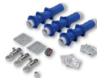
4.2.4.21 Концевая муфта холодной усадки внешней установки СОТ1 для одножильного кабеля с изоляцией из сшитого полиэтилена с медным проволочным экраном типа АПвЭП (ПвЭП, АПвЭПг, АПвЭВ). Для оконцевания экрана в комплект включены кабельные наконечники. Комплект трехфазный.
