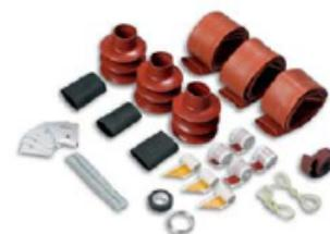
4.2.2.2 Концевая муфта СОТ1 для одножильного кабеля с изоляцией из сшитого полиэтилена с медным проволочным экраном типа АПвЭП (ПвЭП, АПвЭПг, АПвЭВ). Комплект содержит компоненты для трех фаз.
