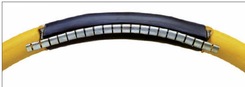
Неподдерживающие горение термоусаживаемые манжеты MRSM предназначены для быстрого и надежного ремонта поврежденных кабелей, использующихся в угледобывающей, строительной промышленности, на транспорте и других аналогичных применениях, где требуется негорючесть и сохранение гибкости. На внутренней поверхности манжет нанесен термоплавкий клей. Металлическую застежку после охлаждения можно удалить.
